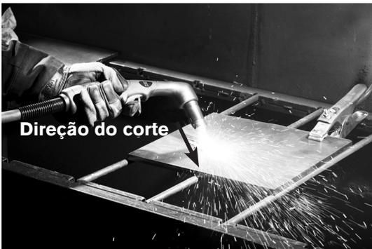
3. Mantenha um ângulo de cerca de 45° em relação à peça de trabalho, enquanto realiza a alimentação da goivagem. Empurre o arco plasma na direção da goivagem que deseja criar. Mantenha uma pequena distância entre a ponta da tocha e o metal fundido para evitar reduzir a vida útil do consumível e causar danos à tocha.
