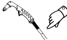
Inspeccione o cabo da tocha. Substitua se estiver avariado.
