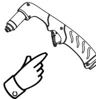
Inspeccione o gatilho para ver se há desgaste. Inspeccione o corpo da tocha para ver se há alguma rachadura ou fios expostos. Substitua qualquer peça avariada.
