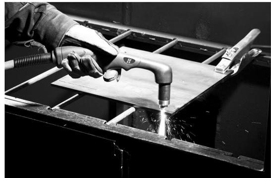
3. Arraste a ponta da tocha levemente através da peça de trabalho para prosseguir com o corte. Mantenha um ritmo regular e estável.
